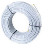
Max. Betriebstemperatur 60 °C , Max. Betriebsdruck 6 bar (FBH-Standarddruck max. 4 bar), Wärmeleitfähigkeit: 0,43 W/mK, Sauerstoffdiffusion im gesamten Anwendungsbereich: <0,005 mg/l d, Oberflächenrauheit k = 0,007 , Biegeradius: 5 x D
