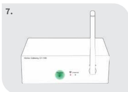
Register-Taste am Gateway kurz drücken, die rote Diode fängt an zu blinken
