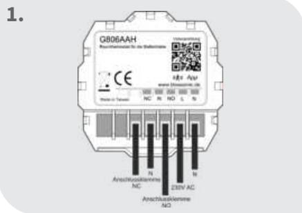
Thermostat wie in der Anschlusskizze verdrahten (230V)
