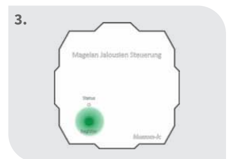
3. „Register“-Taste an der Jalousiensteuerung 3 Sek. drücken
