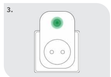
3. Knopf auf der Vorderseite der Steckdose 3 Sek. drücken
