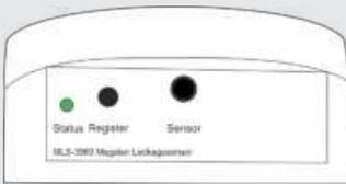
LED am Steuerelement fängt an zu blinken, Leckagesensor registriert sich
