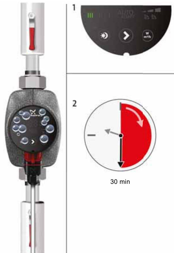
Abb. 8 Entlüften der Pumpe
