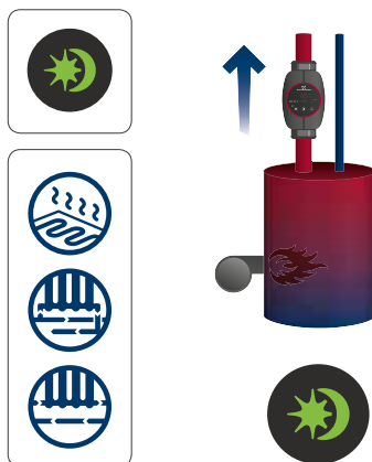
Abb. 21 Voraussetzungen für die automatische Nachtabsenkung
