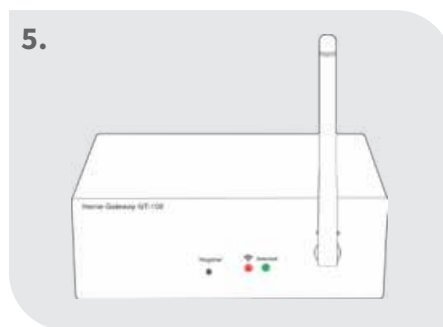
5. Beide Dioden leuchten dauerhaft: Gateway aktiv
