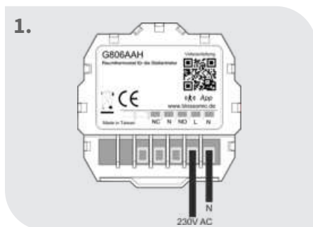
1. Thermostat wie in der Anschlusskizze verdrahten (230V)
