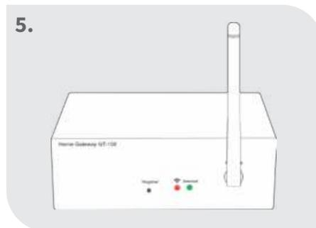
Beide Dioden leuchten dauerhaft: Gateway aktiv
