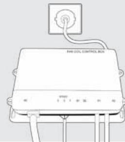
Fan-Coil Control Box mit dem Strom verbinden
