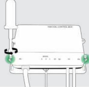
Fan-Coil Control Box zuschrauben
